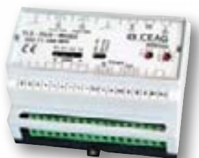
External TLS module
